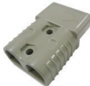
SIG963372 Connecteur pour chariot élévateur • 175A • Pour câble 50 mm 2 • \text{kg} 0,15 kg
